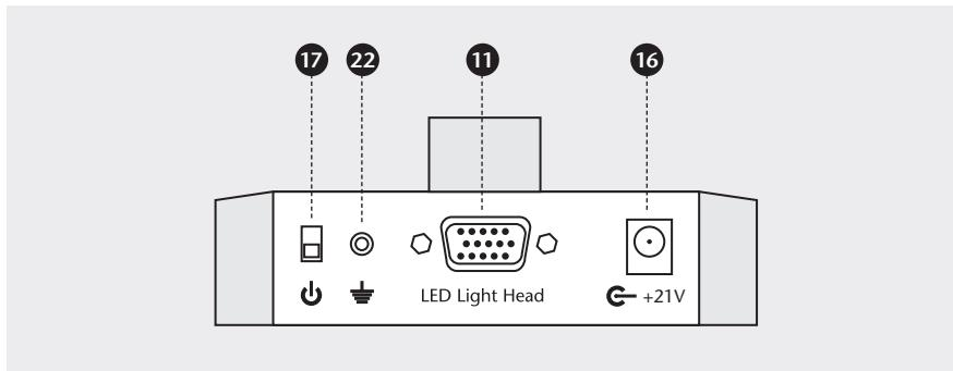
**⑯ Anschluss Beleuchtungseinheit**
